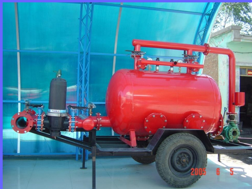
移动式过滤设施
